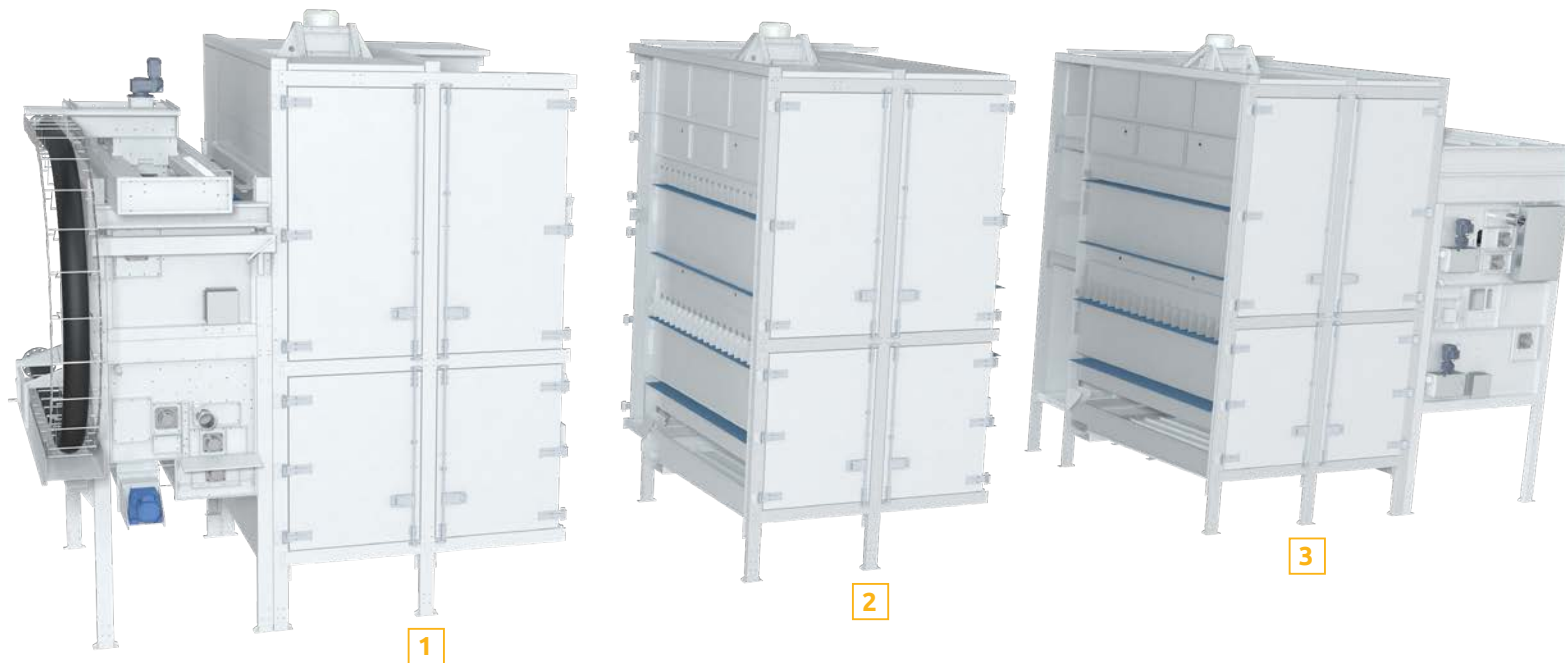
1 = Ein- und Austragsmodul | 2 = Zwischenmodul: Stückzahl skalierbar | 3 = Umkehrmodul
